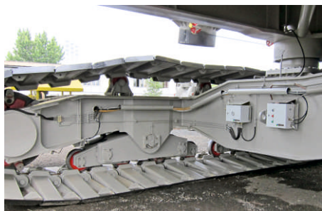
Система смазки на ходовой части экскаватора
