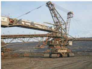
Отвалообразователь (абзетцер) ZPDH 6300.1-CZ 342 точки смазки
