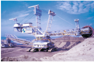
Экскаватор SchRs 1320/4x30 653 точки смазки
